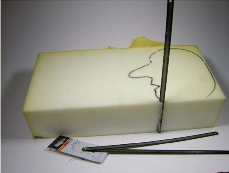
Schaumstoff kann mit einem Eisensägeblatt oder mit einem Elektroküchenmesser sehr leicht bearbeitet werden.
